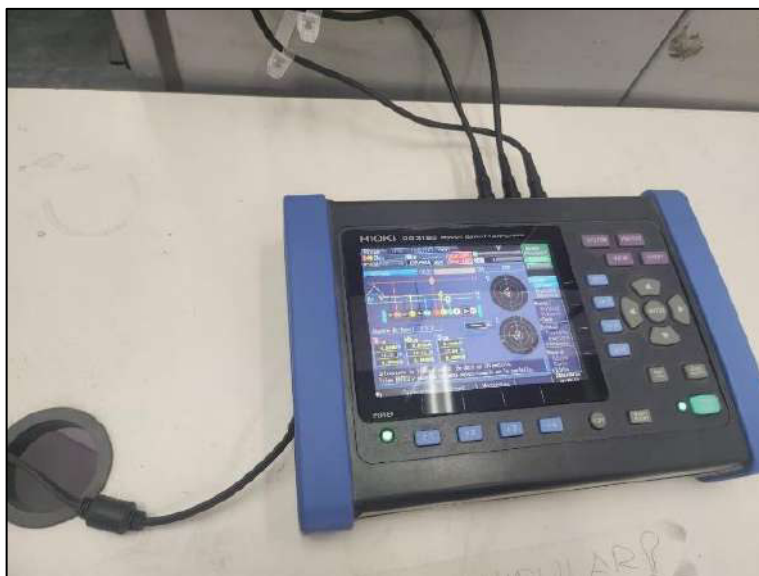
Figura 50 Equipo de medición instalado en sala 1100-ER-011, lado 13.8kV (Corriente). Fuente. Elaboración propia
