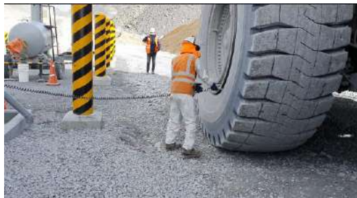
Figura 107 Aterramiento de camión minero. Fuente. Fotografía propia.
