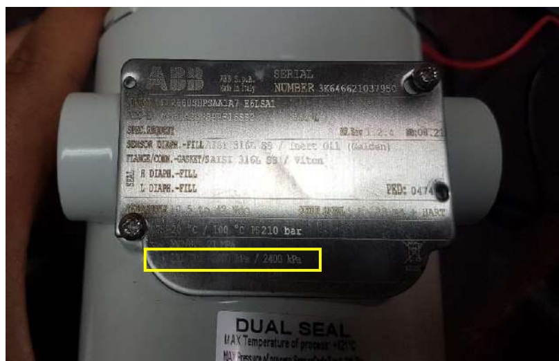
Figura 47 Placa de instrumento DPIT. Fuente. Fotografía propia.
