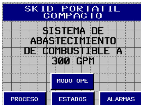
Figura 171 Pantalla Home de HMI. Fuente. Elaboración propia.
