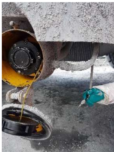
Figura 94 Ajuste y limpieza de línea de sensado del Sensor JET. Fuente. Fotografía propia.
