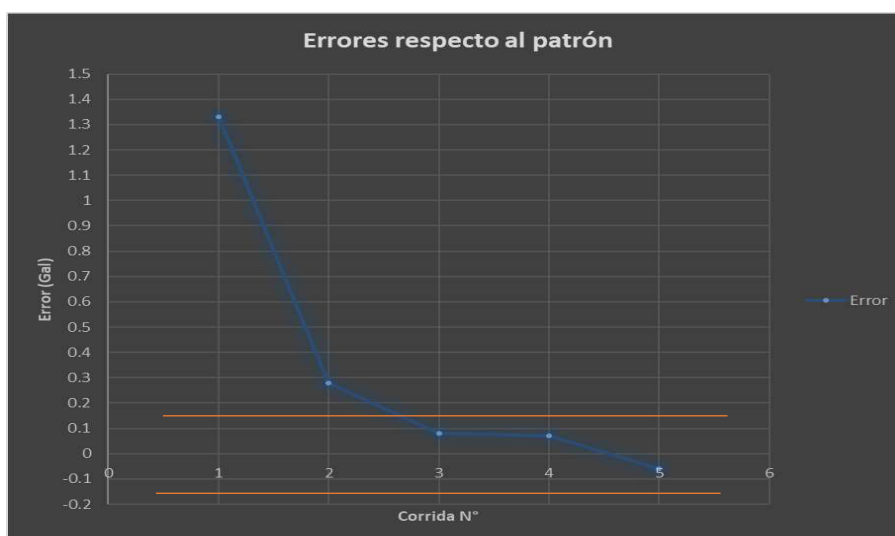
Figura 220 Margen de error del proceso de calibración de FQIT-001. Fuente. Elaboración propia.
