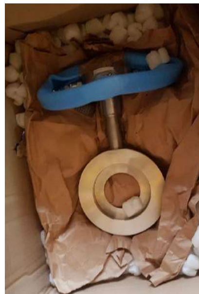
Figura 37 Plato orificio junto a manifold. Fuente. Fotografía propia.
