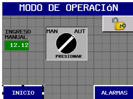
Figura 204 Selección de tipo de control automático o manual. Fuente. Elaboración propia.
