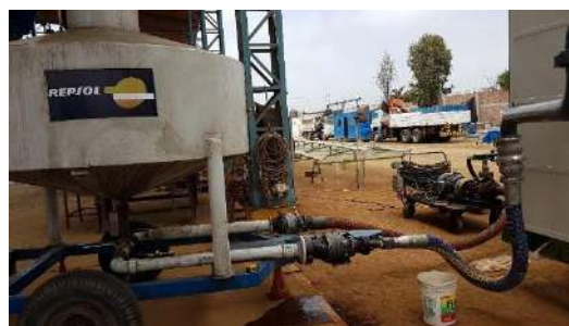
Figura 61 Patrón volumétrico de 560 galones. Fuente. Elaboración propia.
