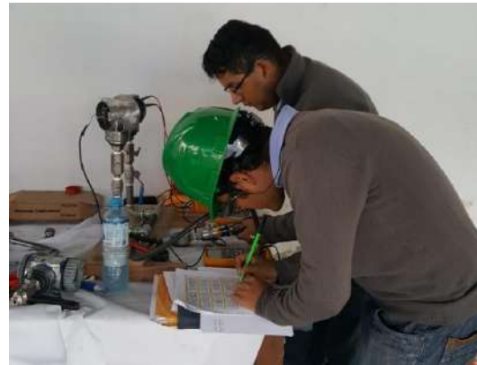
Figura 212 Proceso de calibración de transmisor. Fuente. Fotografía propia.
