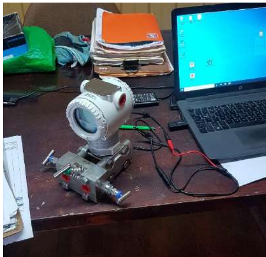
Figura 118 Verificación estado de DPIT con Modem Hart. Fuente. Fotografía propia.
