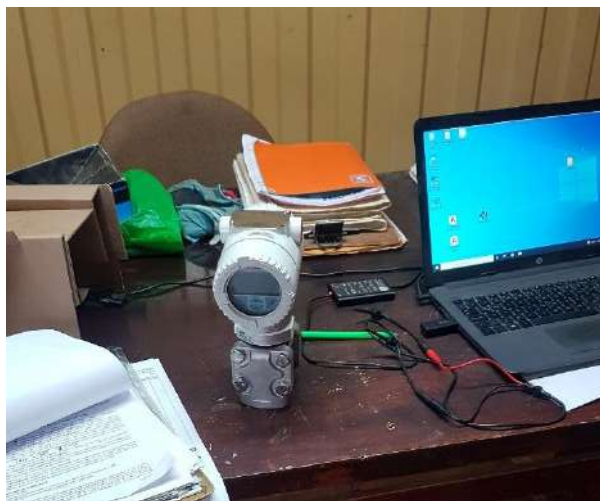
Figura 36 Medidor de flujo diferencial. Fuente. Fotografía propia.
