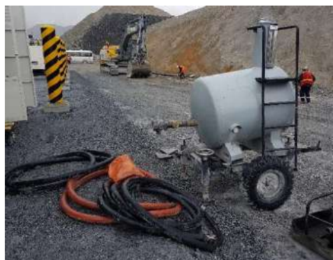
Figura 62 Patrón volumétrico de 320 galones. Fuente. Elaboración propia.
