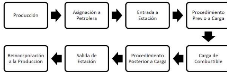
Figura 17 Proceso de abastecimiento de combustible. Fuente. (Bonzi Ríos, 2016)
