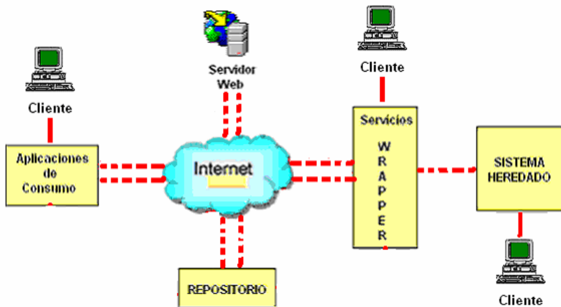
FIGURA. 4.3 Arquitectura Conceptual de Integración de Sistemas Heredados utilizando Web Services
