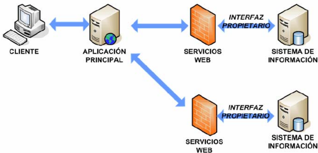
FIGURA. 4.1 Arquitectura de Diseño General de Sistemas Heredados usando Web Services
