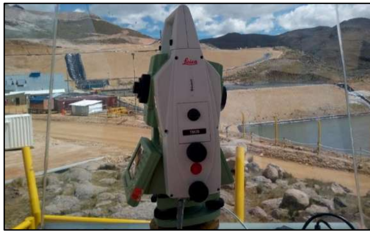
Figura 12: Estación total de monitoreo automatizado Leica TM30 sistema GEOMOS.
