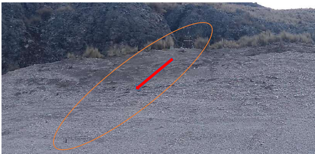
Figura 25: Extensómetro EXT – M19 – 06 instalado.
