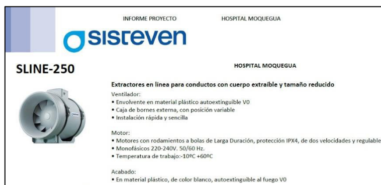
Figura 40. Características Generales Extractor Helicocentrífugo SLINE-250 (SISTEVEN, 2016)
