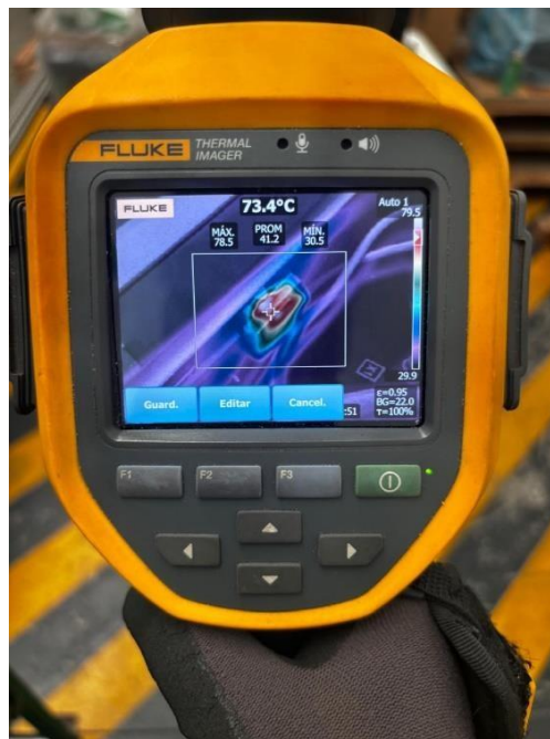
Figura 103: 4ta medición de temperatura y humedad en falla
