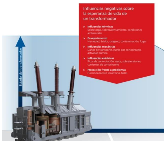
Figura 13: Influencia negativas en transformadores
