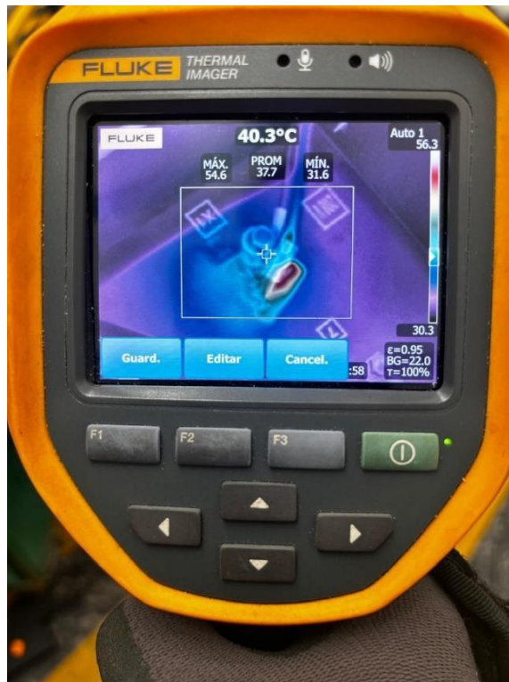
Figura 97: 4ta medición temperatura fase 1 en falso contacto
