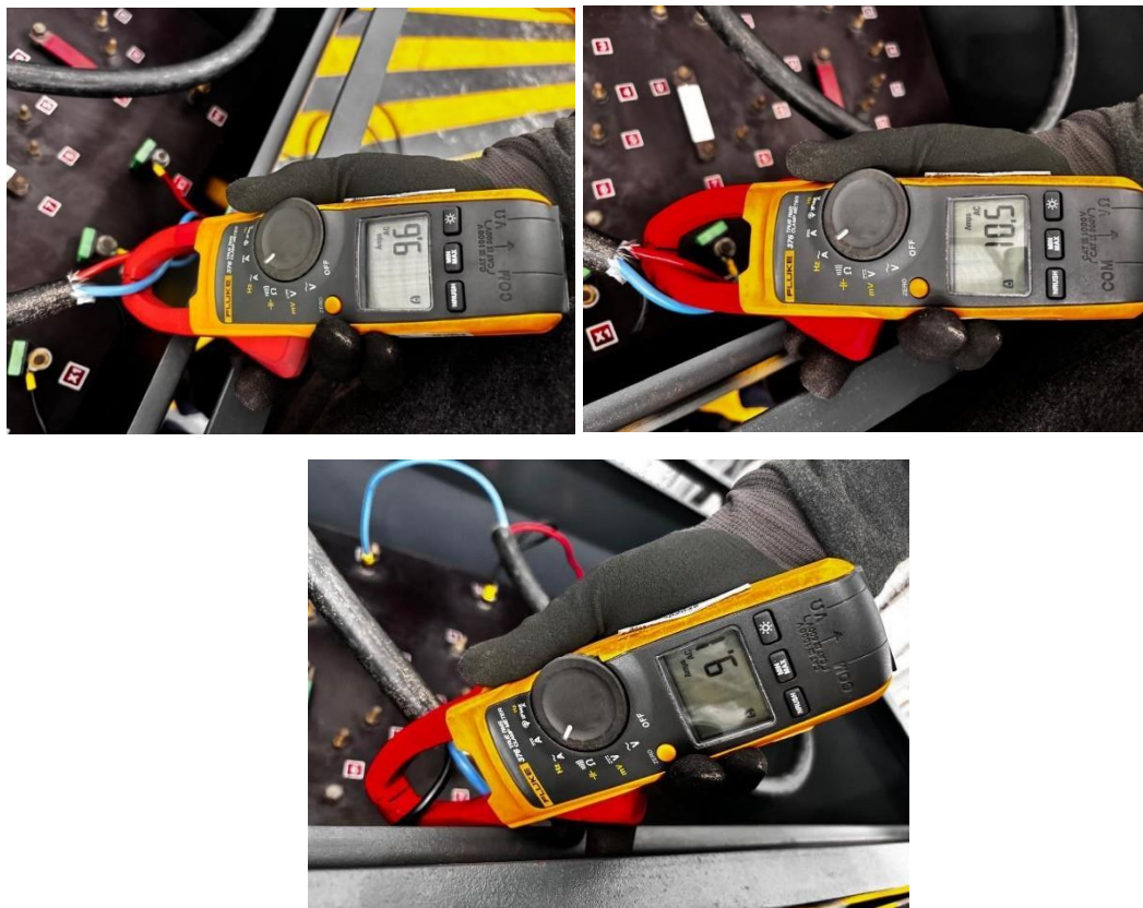
Figura 80: Corrientes en la entrada del transformador
