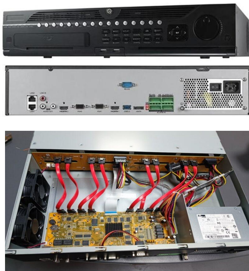
Figura 8 Parte interna del NVR.
