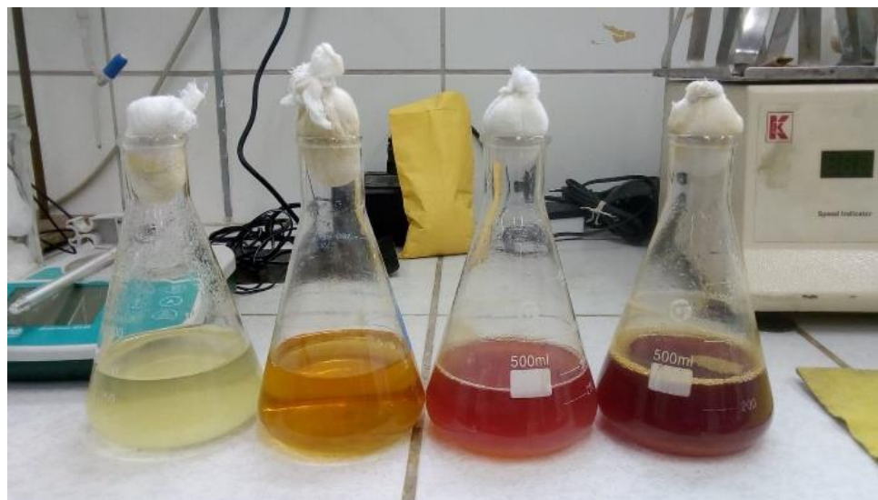
Figura N° 94. Cepas bacterianas de Acidithiobacillus ferrooxidans reactivadas para ser usadas en el pretratamiento. Se observa como las bacterias oxidan principalmente el ion ferroso del 9K líquido de izquierda a derecha, siendo el color más intenso (rojo) indicador de la presencia del ion férrico.
