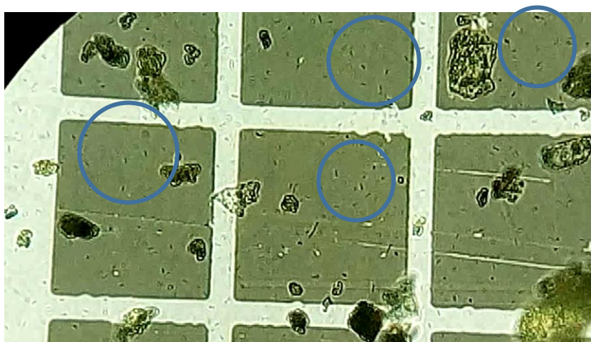
Figura N° 39. Fotografía de Thiobacillus ferrooxidans (dentro de los círculos azules) vista a 1,000 aumentos en la cámara de Neubauer en el microscopio óptico al finalizar la tercera y última etapa de biolixiviación en 65.23% -200 mallas.
