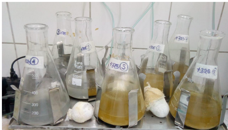
Figura N° 36. Shaker con las muestras en la tercera etapa del pretratamiento en 65.23% -200 mallas. Se observan diferencias en el color de las muestras debido a la concentración de hierro en solución, siendo las de color gris las de menor recuperación en hierro. Fuente: Imagen tomada en el laboratorio de Biometalurgia
