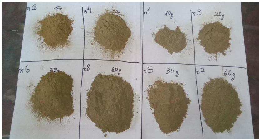
Figura N° 61. Resultado de las muestras en 50.27% -325 mallas pretratadas para su posterior cianuración. Fuente: Imagen tomada en el laboratorio de Biometalurgia
