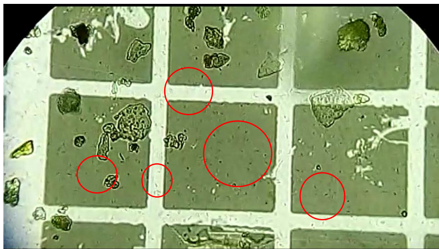
Figura N° 22. Fotografía de Thiobacillus ferrooxidans (dentro de los círculos rojos) vista a 1,000 aumentos en la cámara de Neubauer en el microscopio óptico al finalizar la tercera y última etapa de biolixiviación en 88.09% -100 mallas.
