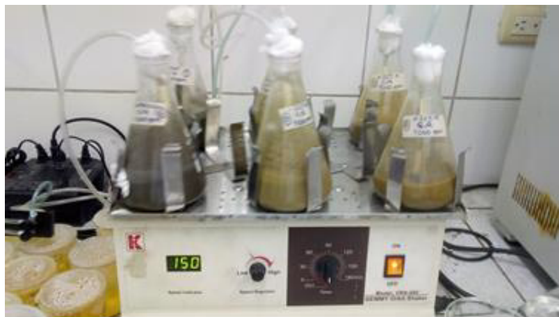
Figura N° 78. Shaker con las 6 muestras (4 pretratadas) cianurándose con aireación a 500 y 1000 ppm. Fuente: Imagen tomada en el laboratorio de Biometalurgia
