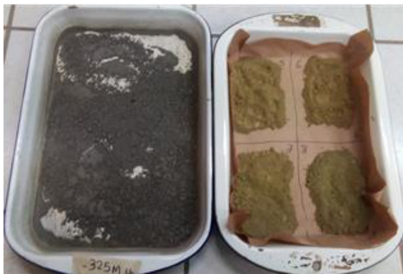
Figura N° 62. Muestra antes y después del tratamiento de biolixiviación en 50.27% -325 mallas. Se observa cualitativamente el cambio de color producto de la oxidación de los principales sulfuros en la muestra. Fuente: Imagen tomada en el laboratorio de Biometalurgia
