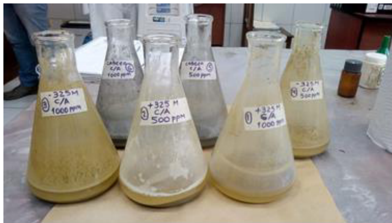
Figura N° 79. Imagen de todas las muestras (6) al término de las pruebas de cianuración listas para filtrar y analizar por oro y plata la solución por Absorción Atómica (AA) y determinar estos mismos metales en el relave mediante vía seca (Fire Assay).
