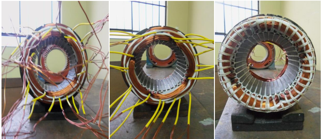
FIGURA N º 3.6: PROCESO DE REBOBINADO DE ESTATOR DE MOTOR SEMIHERMETICO DE REFRIGERACION DE 10 HP
