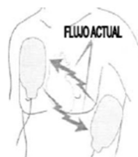
Figura 8 Flujo de corriente eléctrica del desfibrilador bifásico. Fuente. Guía Tecnológica No. 29: Desfibriladores , por CENETEC (2005).
