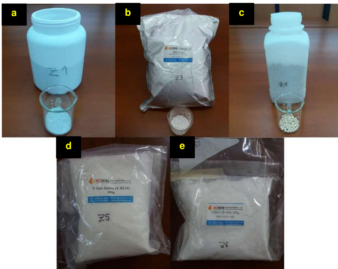
Figura 19 Catalizadores usados en este estudio: a) catalizador de equilibrio de FCC, b) Zeolita ZSM-5 (G360) gránulo, c) Zeolita ZSM-5 gránulo, d) Zeolita Y (Y-RE16) polvo, e) Zeolita ZSM-5 (P-360) polvo.
