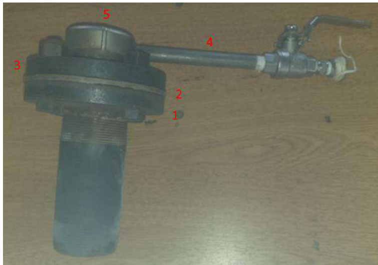
Figura 21 Reactor de pirólisis y accesorios: 1) Brida inferior, 2) Empaque de alta temperatura, 3) Brida superior, 4) Salida de los gases de pirólisis, 5) Termopozo.
