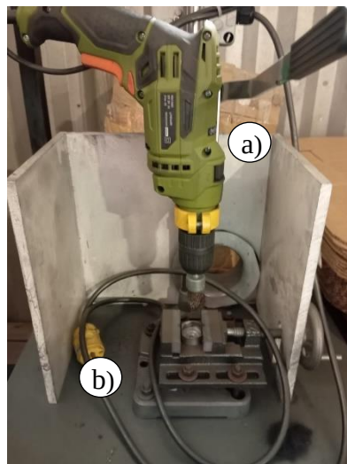
Figura 3. Pulidor de crisoles. a) Pulidor de crisoles de grafito. b) Base fija porta crisoles.
