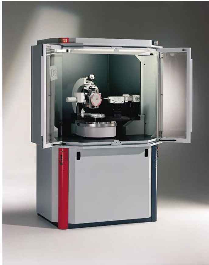
Figura 11: Difractómetro de polvo típico. Los difractómetros de rayos X constan de tres elementos básicos: un tubo de rayos X, un portamuestras y un detector de rayos X.
