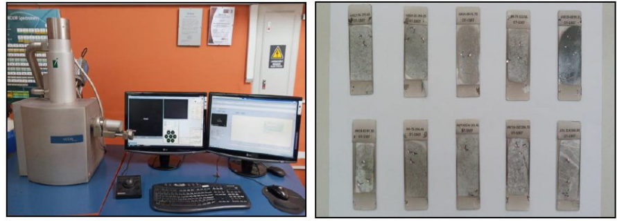
Figura 15: Secciones analizadas por el microscopio electrónico de barrido (Izq.). Secciones delgadas pulidas (Der.)
