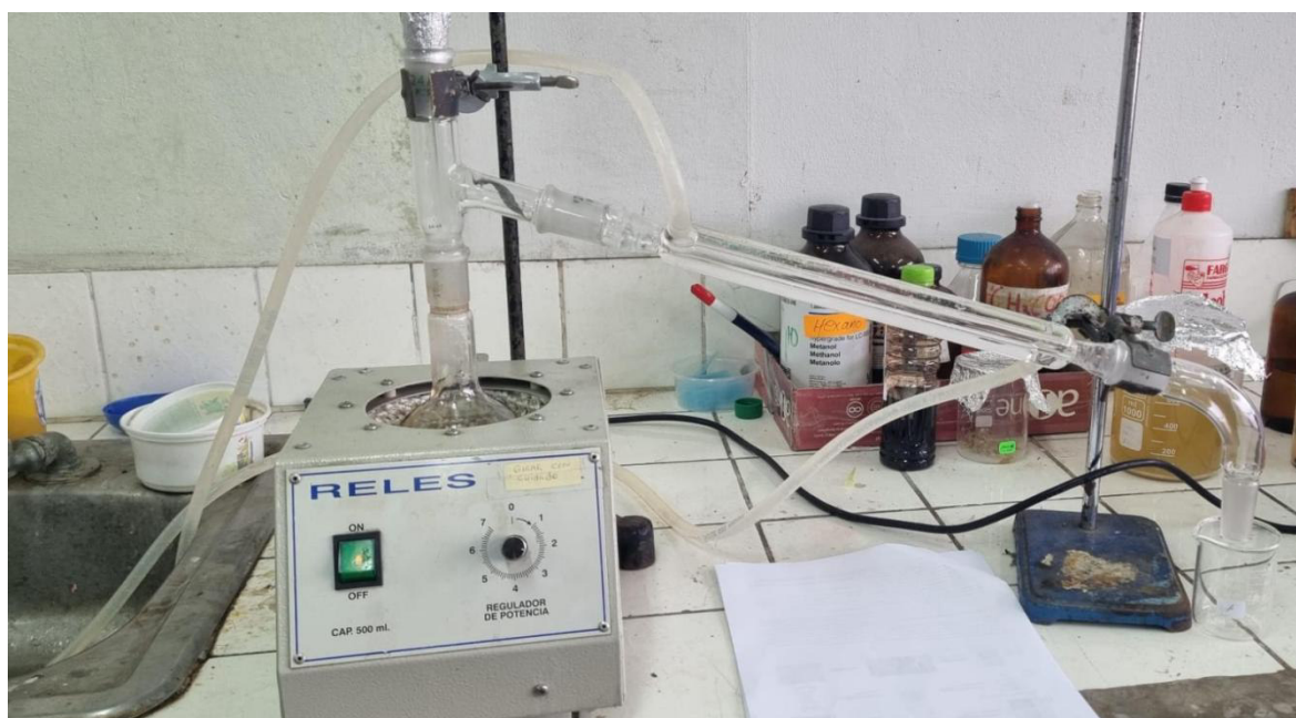
Figura 18. Destilación simple del aceite lubricante usado
