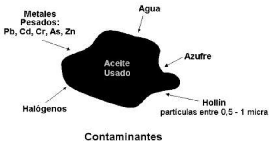
Figura 8. Contaminantes presentes en los aceites lubricantes
