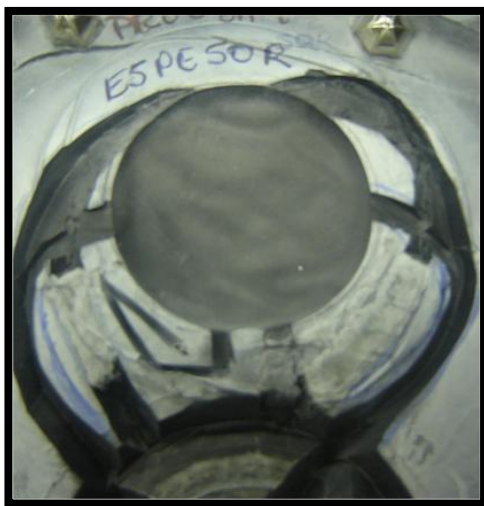
Fig. 17- Molde con cuatro entradas laterales
