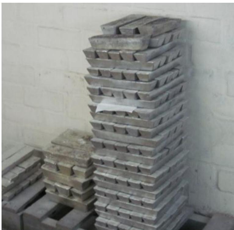
Fig.7 Aleación de Metal Blanco (36% Sn y 58% Pb)
