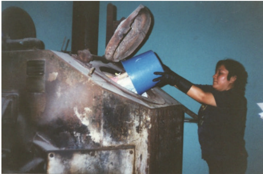
FOTO N° 9: Tratamiento de residuos (incineración) en equipos no adecuados.
