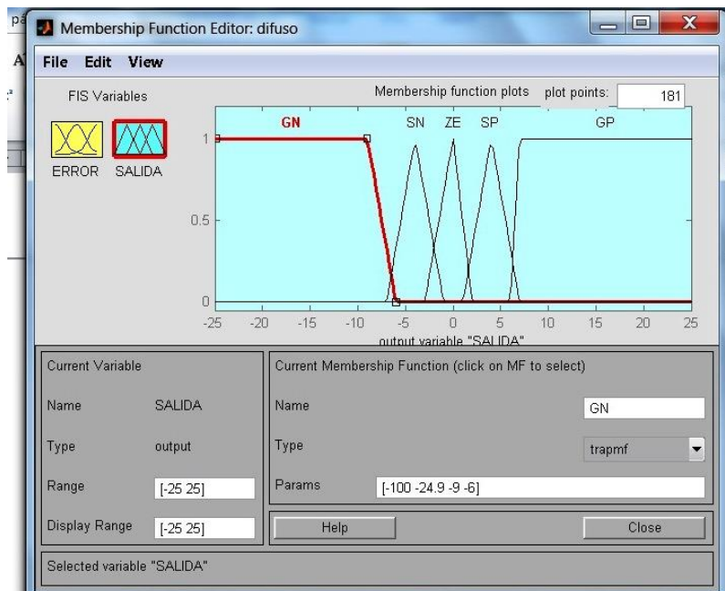
Figura 4.5 El Conjunto Difuso de Salida en Fuzzy Logic Toolbox
