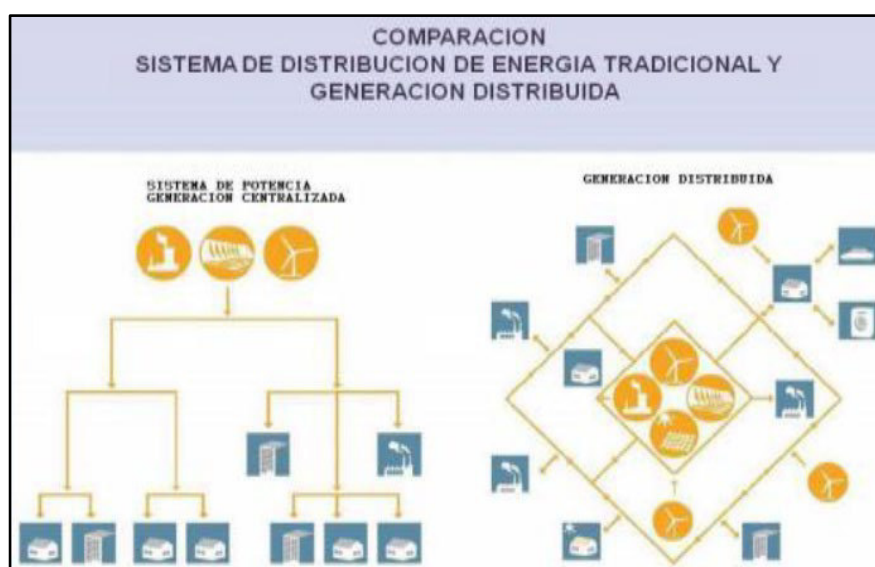
Figura 4. Sistema de distribución tradicional y generación distribuida.
