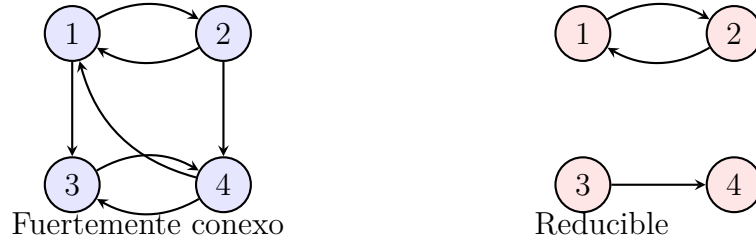
Figura 2.26: Ejemplo de dígrafo ponderado: (izquierda) fuertemente conexo, equivalente a una matriz irreducible; (derecha) reducible, equivalente a una matriz reducible.
