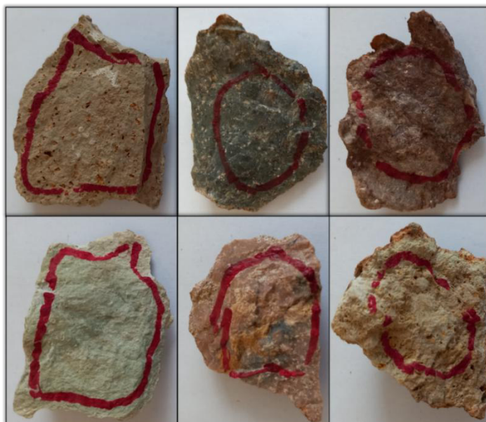
Figura N°44. Muestras de rocas señalizadas donde ocurre la alteración mineral para la toma de datos con el TerraSpec Halo.
