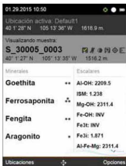
Figura N°48. Pantalla incorporada al espectrómetro TerraSpec Halo, donde se puede visualizar los resultados obtenidos de manera inmediata.
