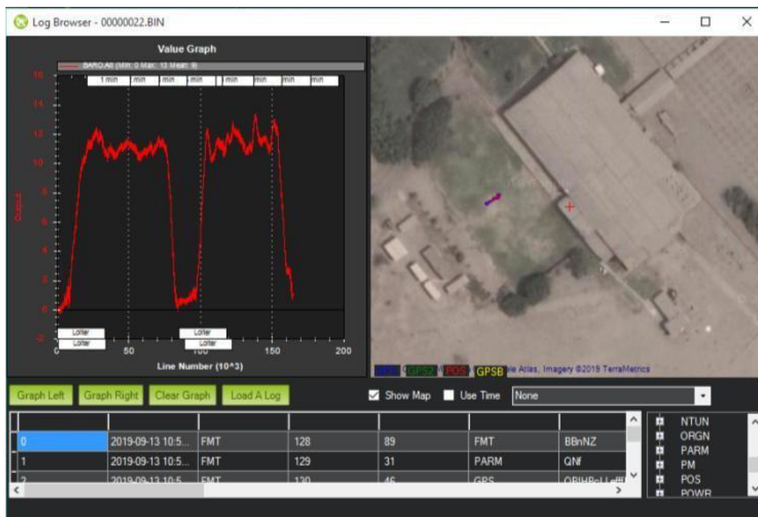
Figura 53. Revisión de log de vuelo en programa Mission Planner. Fuente: Elaboración propia.
