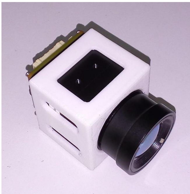
Figura 54. Cámara térmica con envoltura impresa en 3D. Fuente: Elaboración propia.
