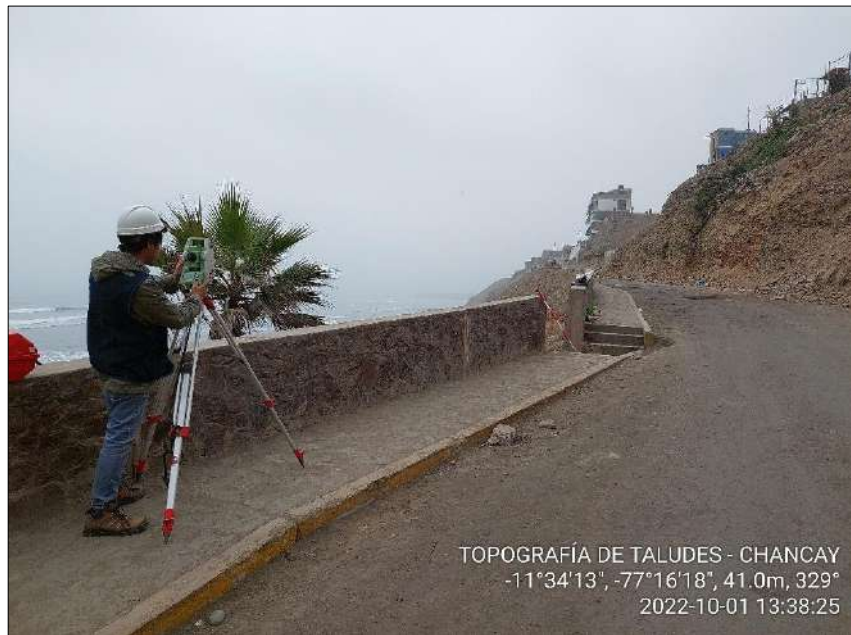
Figura 23. Levantamiento topográfico de los taludes. El Autor (2022)
