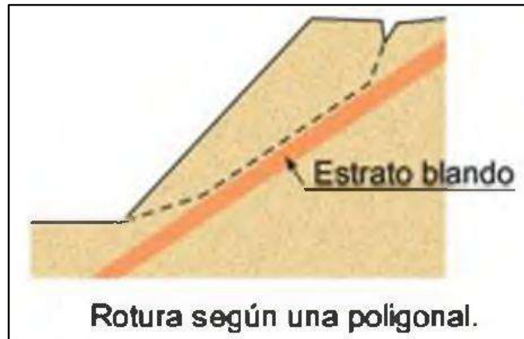
Figura 6. Tipo de falla circular poligonal de talud en suelos.
