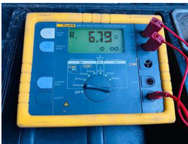
Figura 39: Toma de lectura de resistencia del pozo a tierra. Fuente: Archivo fotográfico de Clear Channel.
