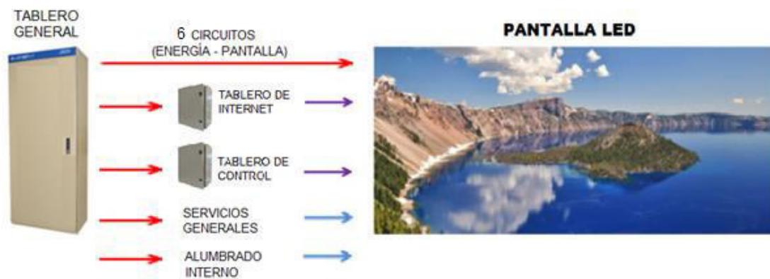
Figura 23: Esquema de control eléctrico para pantalla led. Fuente: Elaboración propia.
