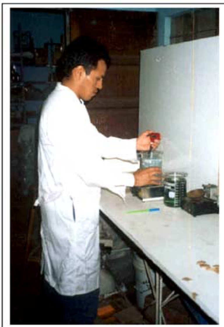
Foto N° 1. Trabajos realizados en los ambientes del Laboratorio de Smallvill SAC. Uso del agitador magnético para la agitación de las pruebas y también del potenciómetro para la medición del pH de la muestra.
