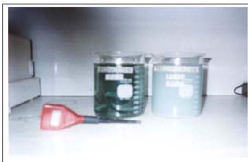
Foto N° 3. Neutralización Química, El cambio de la coloración de verde oscuro proveniente de la primera etapa a verde claro (verde nilo), se debe a la adición de la cal para precipitar el cromo en forma de hidróxido.
