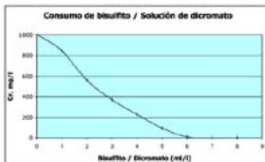
Figura 7. Curva del Consumo del bisulfito de sodio
