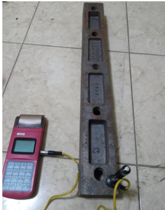
Gráfico 24 - Medición de dureza de martillo utilizando durómetro portátil
