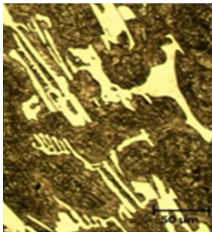
Gráfico 49 - Microestructura de la pieza desestabilizada a 1020°C con 3 horas de permanencia.
