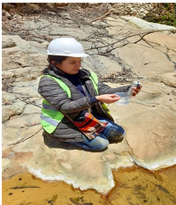
Figura 4. Medición de parámetros fisicoquímicos con el multiparámetro PCTS Testr 50 marca OAKTON en el punto PS-01.
