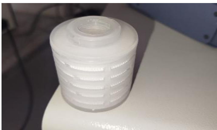
Figura 26 Sustitución de filtro de aire de igualación con impurezas.
