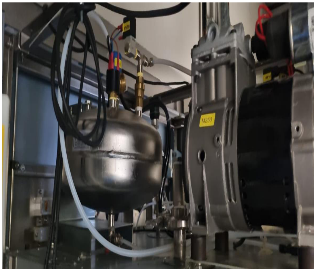
Figura 10 Sistema de Aire Comprimido. Fuente. Elaboración propia
