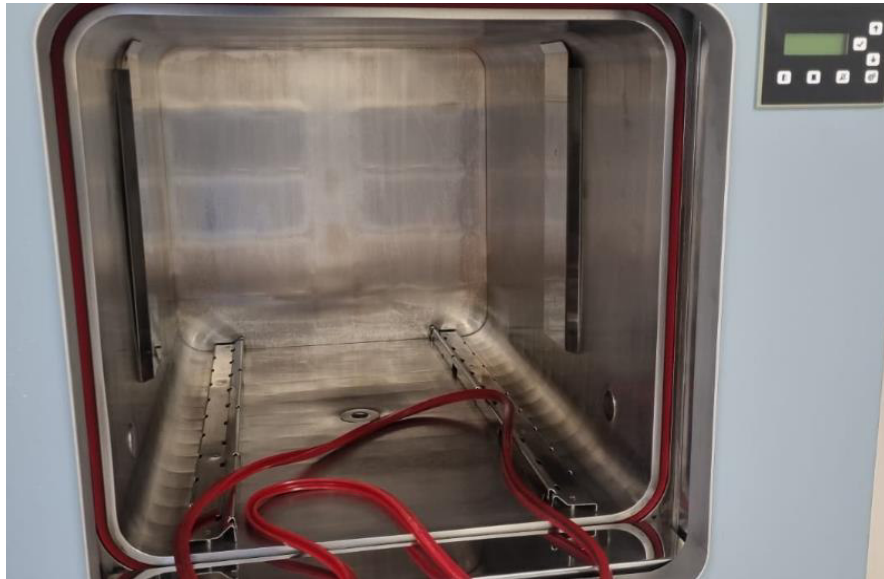
Figura 28 Reemplazo de junta de puerta de cámara. Fuente: Elaboración propia
