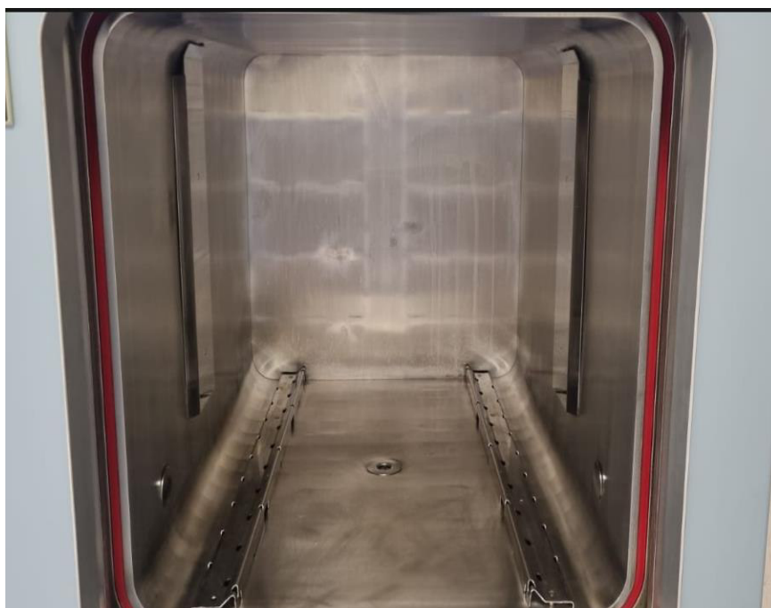
Figura 8 Cámara de esterilizador a vapor. Fuente. Elaboración propia
