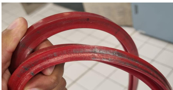
Figura 27 Verificación de junta de puerta de cámara. Fuente: Elaboración propia
