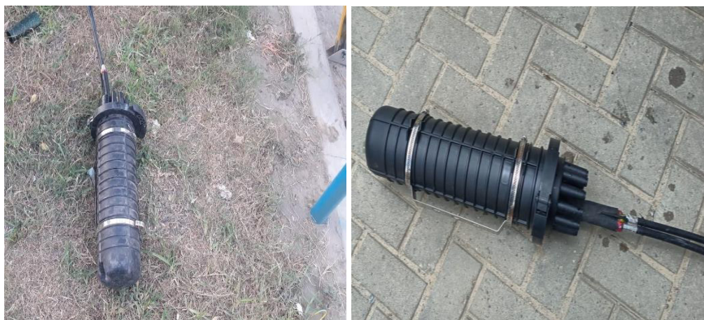
Figura 13: Mufas Domo tipo Bala (soporta 6 cables 96H SM). Fuente: Elaboración Propia
