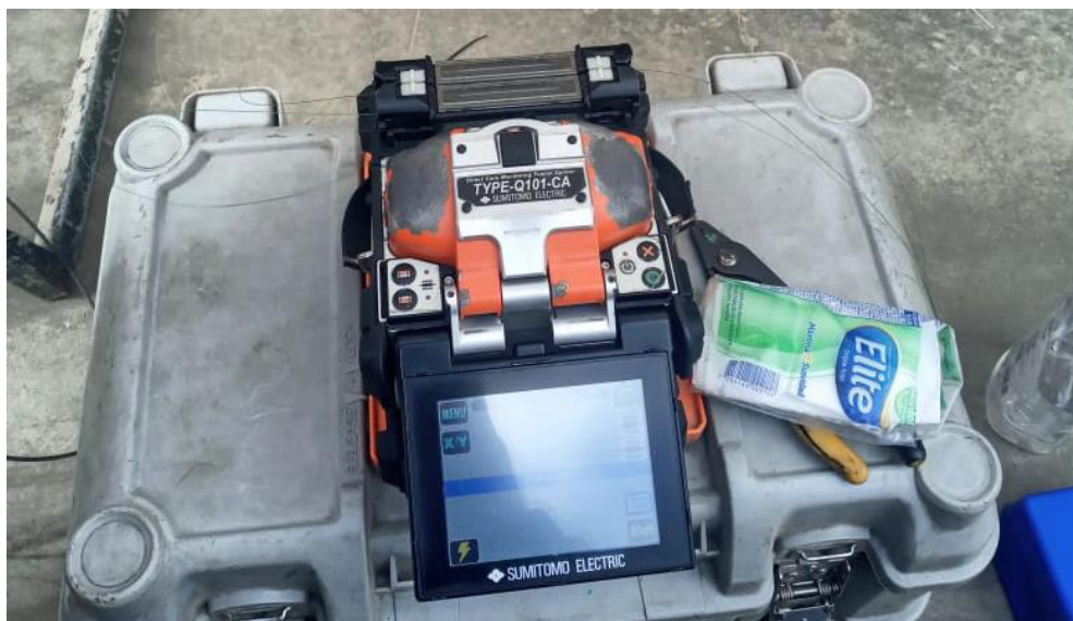
Figura 19: Empalmadora de F.O de la marca Sumitomo Electric. Fuente: Elaboración Propia
