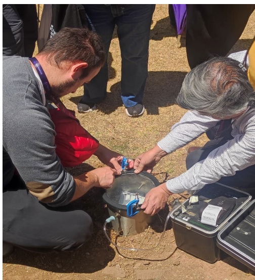
Figura 3. (a) Conexión del acumulador de acero inoxidable al monitor RAD7 mediante mangueras de entrada y salida de aire. Este sistema permite el flujo controlado del radón acumulado hacia el detector para la medición activa en tiempo real.
