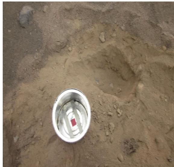
Figura 2. Preparación del área de muestreo y colocación del acumulador en el orificio excavado. El dispositivo se ajusta al suelo para permitir la acumulación del radón emanado desde la superficie durante la medición.
