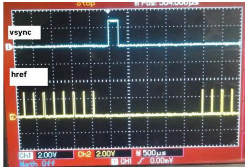
Fig. 4.- Pulsos VSYNC y HREF captados por el osciloscopio. Fuente: elaboración propia
