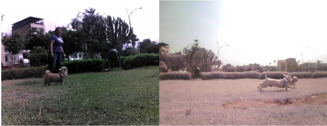
Fig. 20.- Imágenes capturadas con exposición directa del sol. A la izquierda: Sensor de 5mp, a la derecha: Sensor de 0.2mp.
