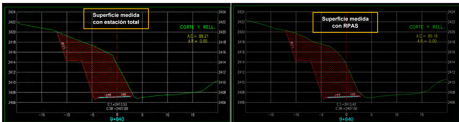
Figura 58. Sección transversal de la progresiva 9+840 del SM-08 con estación total y RPAS.
