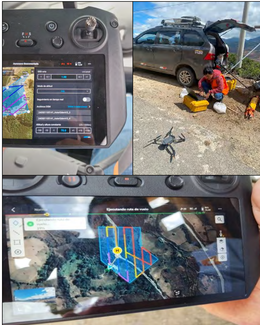
Figura 39. Vuelo fotogramétrico de los sectores de mejoramiento.
