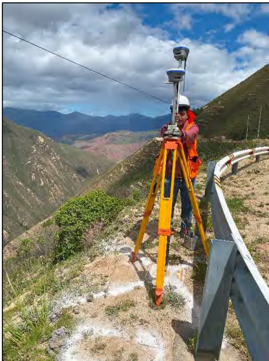
Figura 36. Verificación del sensor IMU del CHCNAV i90.
