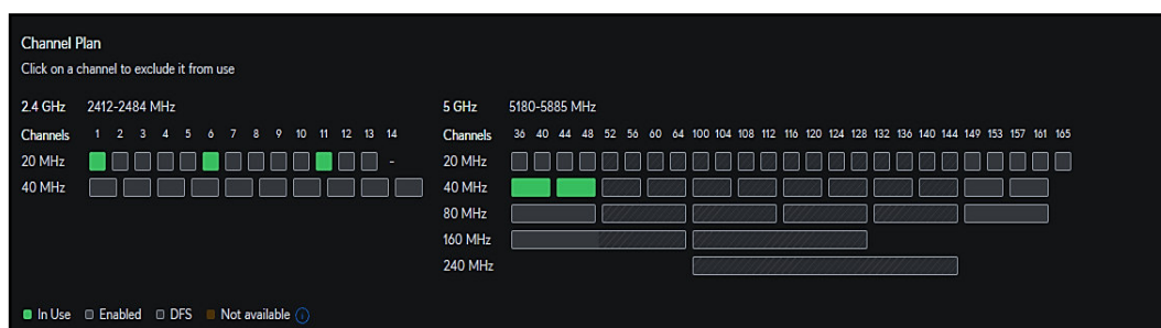
Figura 29 Plan de canales. Fuente. Omnisys/Dashboard UniFi (2025)
