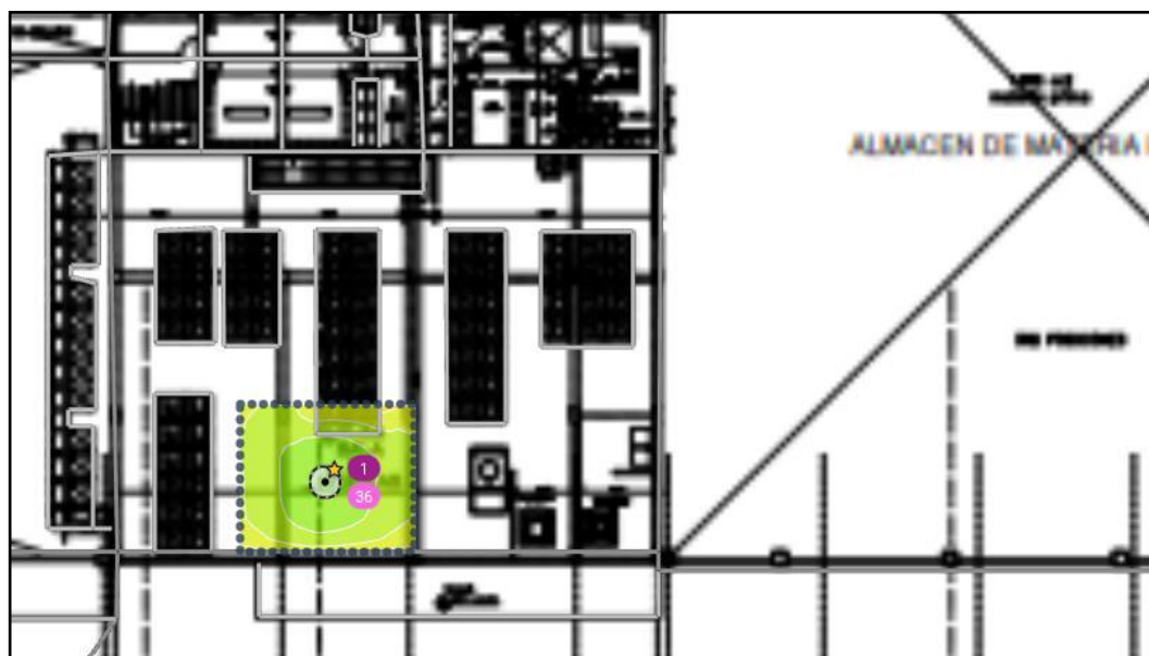
Figura 17 Cobertura en 2.4GHz Piso 2. Fuente. Omnisys (2025)
