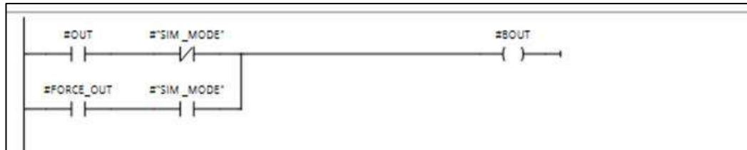
Figura 24: Lógica de bloque de función IO_DO. Fuente: Elaboración propia (2025).
