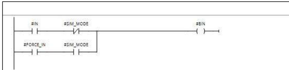
Figura 22: Lógica de bloque de función IO_DI. Fuente: Elaboración propia (2025).
