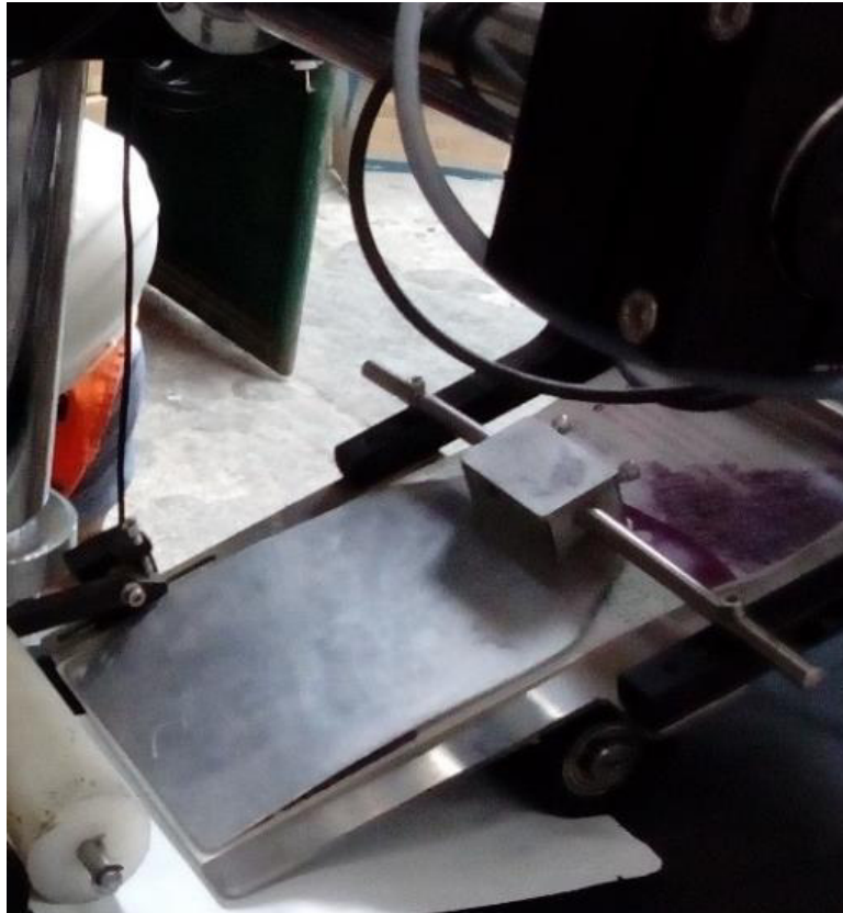
Figura 28: Primera instalación fue con un rodillo de nylon a la salida
