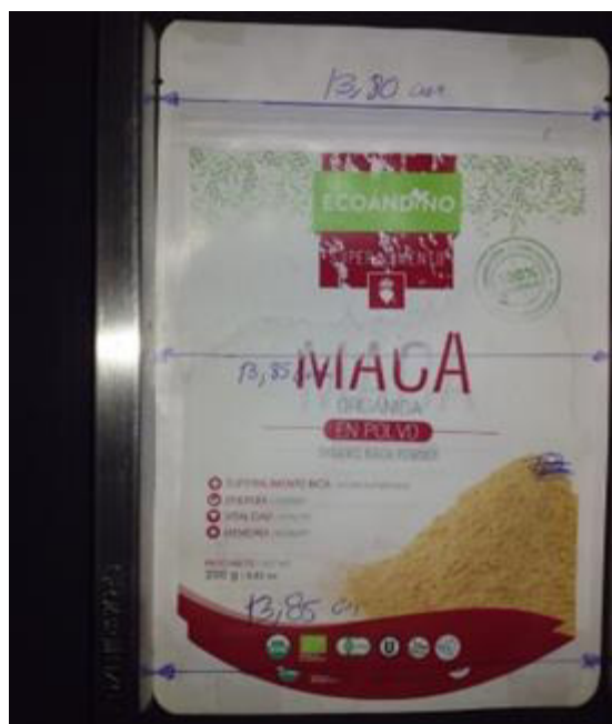
Figura 43: Medidas del ancho del sobre con márgenes de variación influye en la precisión de etiquetado lateral
