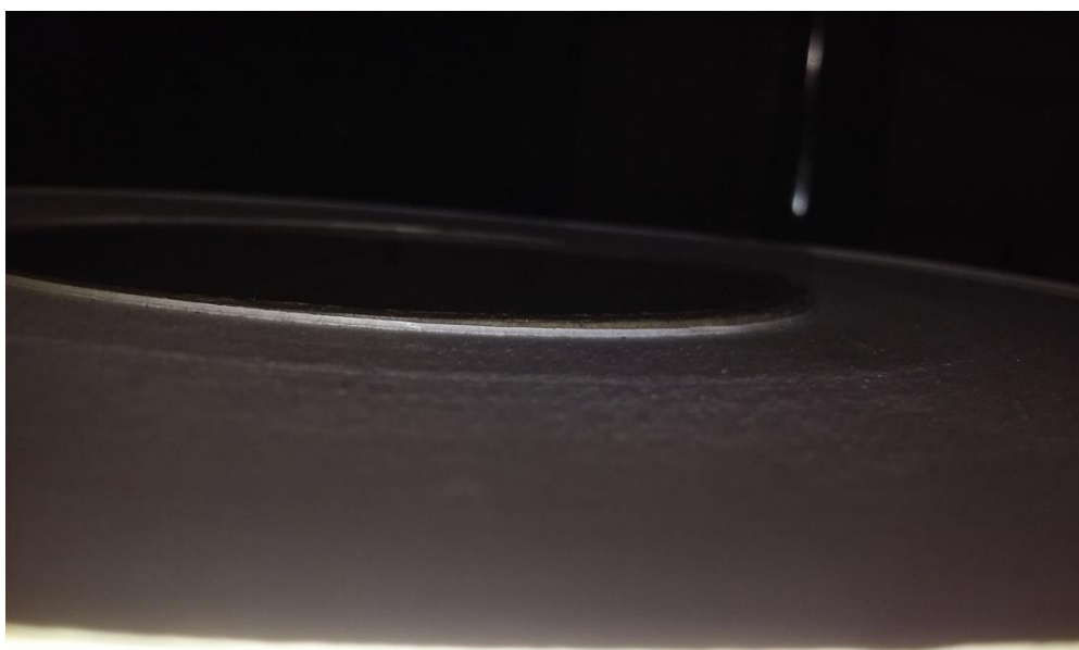
Figura 44: Rollos de etiqueta con cartón interno sobresaliente influye en la precisión de etiquetado horizontal
