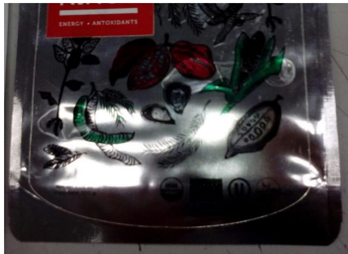
Figura 29: Presencia de bolsas de aire o burbujas de aire luego del etiquetado con rodillo de nylon
