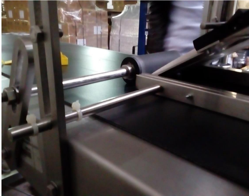
Figura 31: Posición del rodillo de goma adelante del etiquetado y con presión hacia abajo
