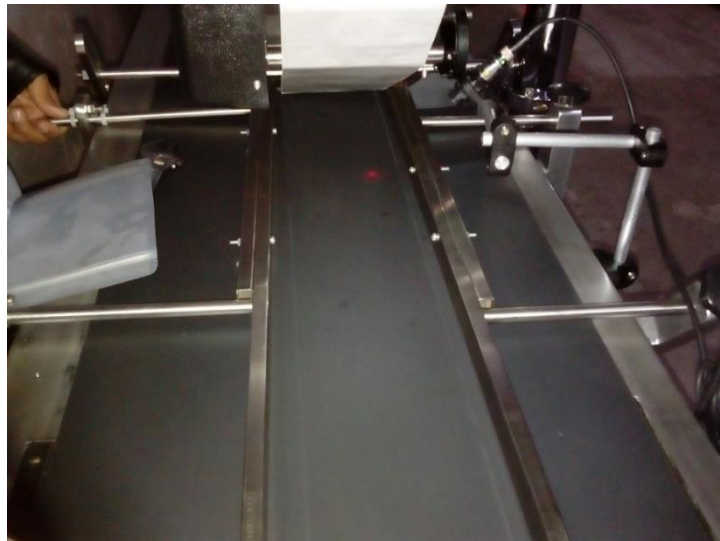
Figura 39: Vista de la ubicación del sensor y del haz de luz que detecta el sobre desplazado
