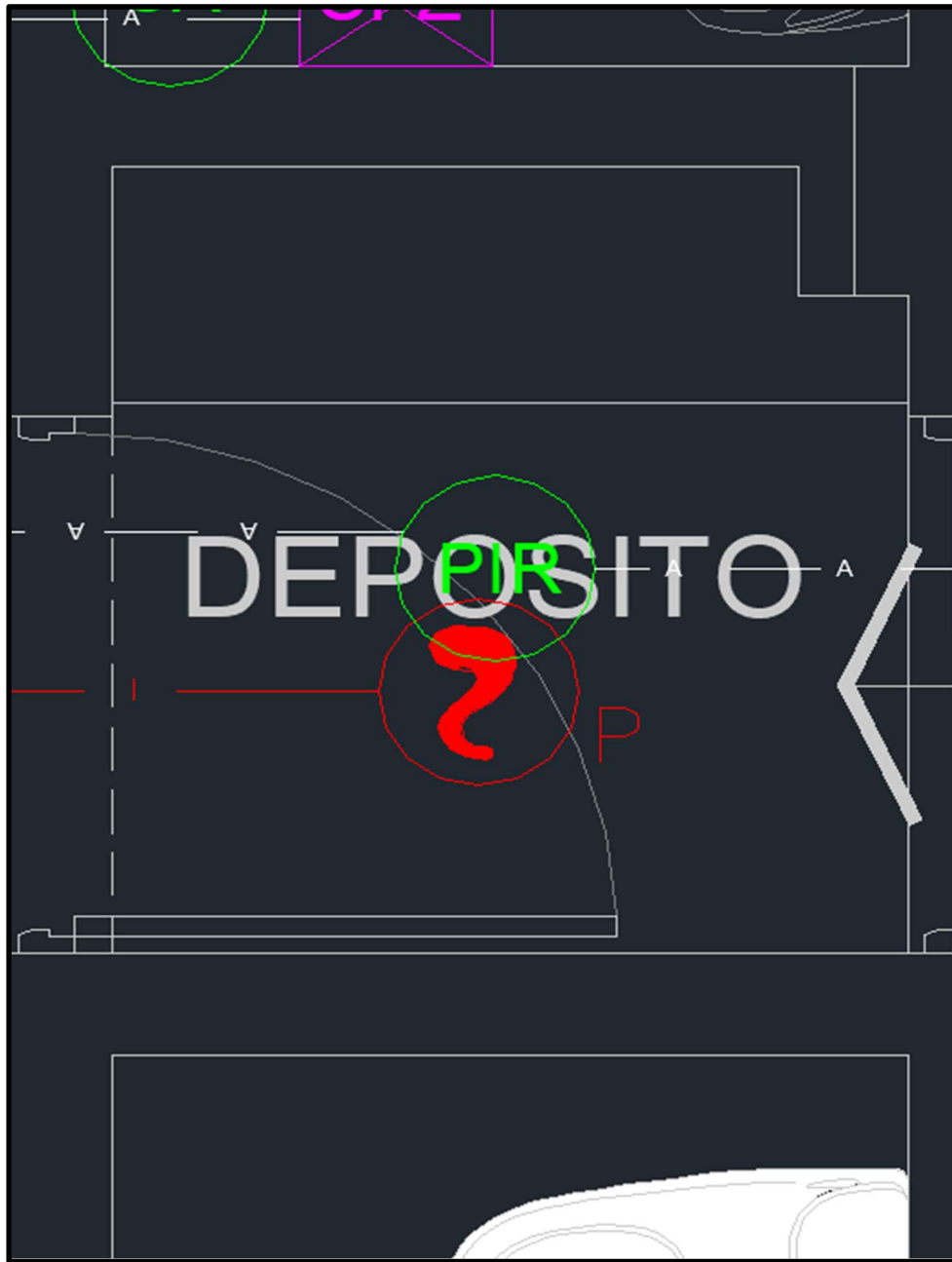
Figura 26 Detector de humo ubicado en un depósito. Fuente. Elaboración propia basada en planos arquitectónicos confidenciales proporcionados por el cliente (2025).
