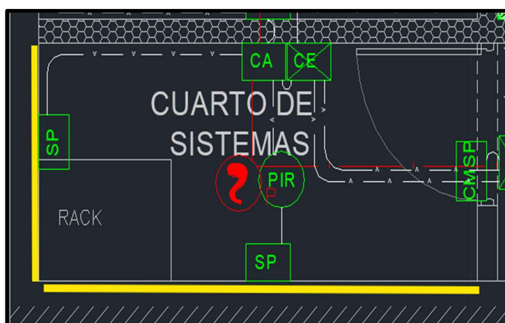
Figura 31 Sensor de percusión (SP) en cuarto de comunicaciones. Fuente. Elaboración propia basada en planos arquitectónicos confidenciales proporcionados por el cliente. (2025).
