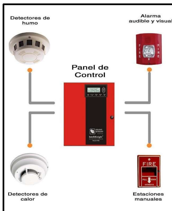
Figura 15 Central de alarmas contra incendio y dispositivos. Fuente. Ajcproyectos (2022).
