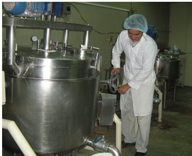
Imagen N° 7.3 – Homogenizador N° 2, en acero inoxidable con grado alimentario 316 L, para la producción de esencias o aromatizantes.
