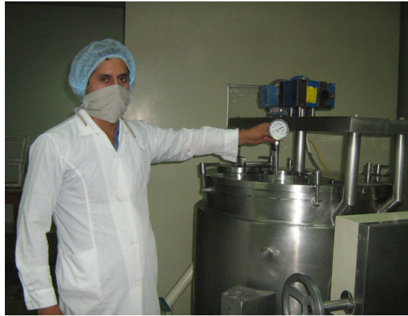
Imagen N° 7.1- Homogenizador N° 1, en acero inoxidable con grado alimentario 316 L, donde se visualiza la medición de Temperatura y Presión en la producción de Jaleas.
