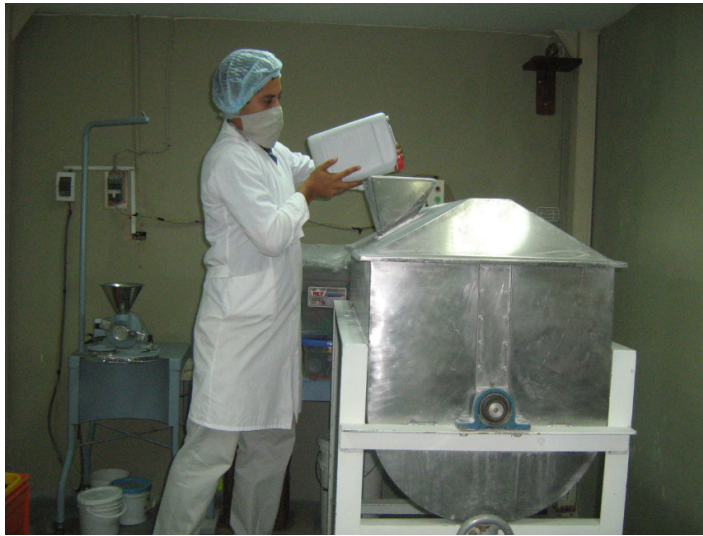
Imagen N° 7.4 – Equipo Mezclador N°1, en acero inoxidable con grado alimentario 316 L, donde se dosifica los insumos para la producción de Polvo de Hornear.
