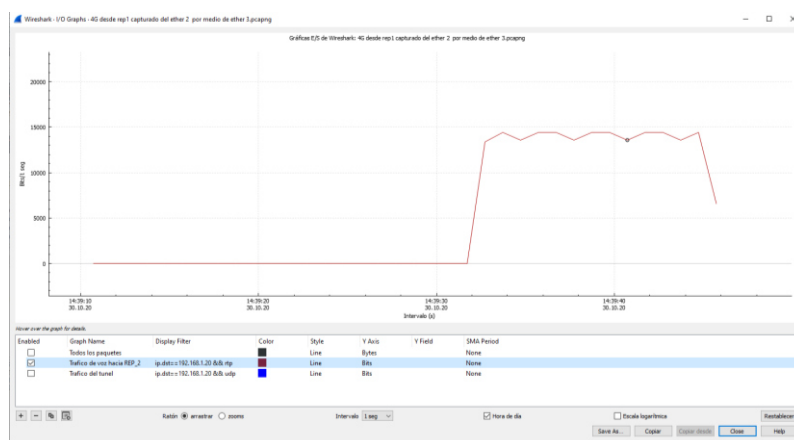
Figura 14. Medición del ancho de banda consumido para llegar a la REP_1. Fuente. Propia
