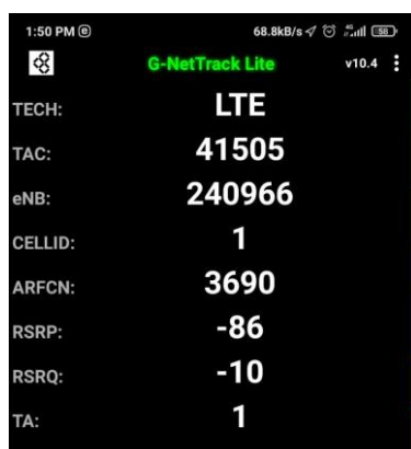
Figura 6. Nivel de intensidad de la red LTE para REP_2. Fuente. Propia
