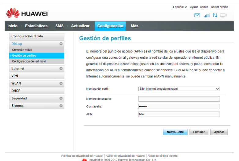
Figura 55. Configuración del APN Bitel. Fuente. Propia
