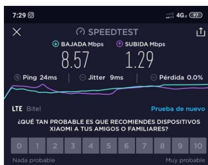
Figura 3. Medición de la red LTE Bitel para el Almacén de Huachipa. Fuente. Propia, setiembre 2020
