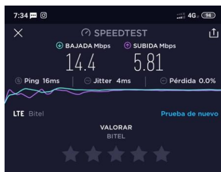
Figura 4. Medición de la red LTE Bitel para el Almacén de Ate. Fuente. Propia, setiembre 2020
