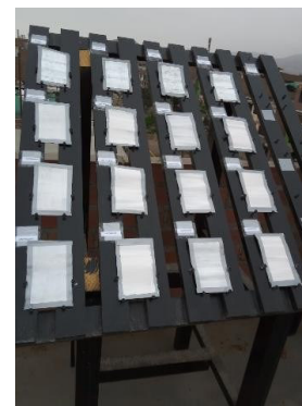
Bastidor sosteniendo las probetas de aluminio
