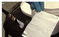
Aplicando el recubrimiento a la probeta y espesor de aplicación a 150 micrómetros
