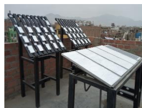
Probetas de aluminio con los recubrimientos colocados en los bastidores y recubrimientos colocados en los paneles solares
