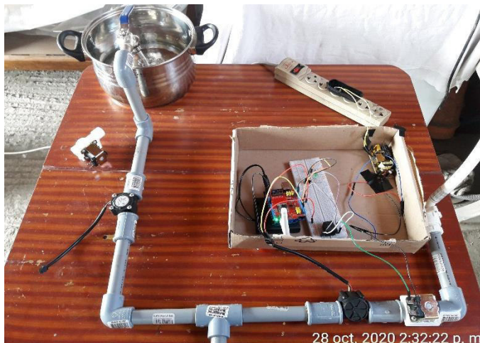
Figura 41: Válvula en ON en sistema – Hay flujo de agua
