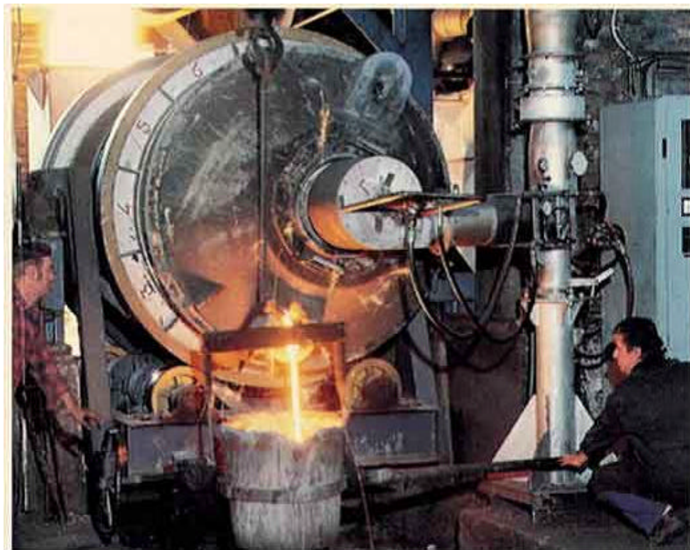
Fig. 4 Vista de la colada de un Horno Rotativo Corto (SRF)
