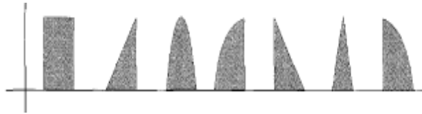
Figura 4: Onda de flujo interrumpido y misma polaridad. Fuente: Grupo de investigación DALCAME
