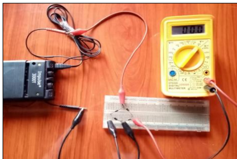
Figura 13: Conexión estimulador-multímetro. Fuente: Elaboración propia
