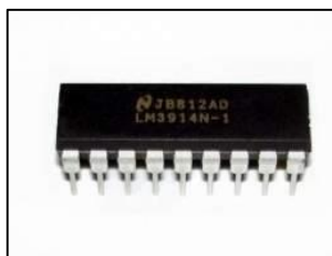
Figura 18: Integrado LM3914. Fuente: https://www.ecured.cu/Integrado_LM3914
