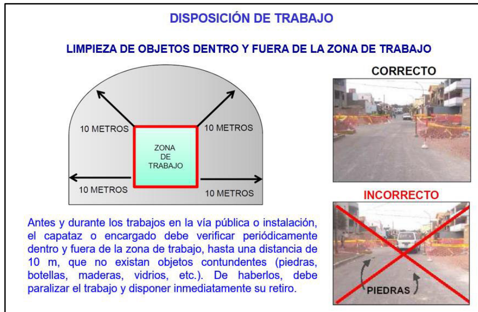
Figura 5. Disposición de trabajo de limpieza de objetos dentro y fuera de la zona de trabajo. Fuente: Elaboración propia
