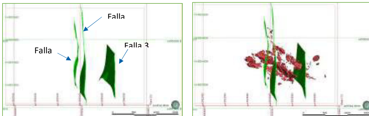
Figura 7.10.- Primer Sistema de Fallas N-S
