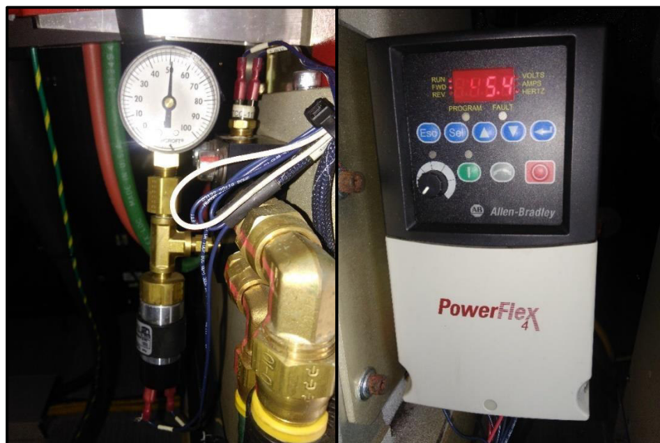
Figura 11. Presión de refrigerante del tubo de rayos X (50 PSI) y frecuencia de giro de la rueda del subsistema tubo e rayos X. Fuente: Elaboración propia.
