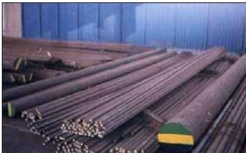
FIG. 4.1. Barras de acero SAE 1045 en estado de Suministro
