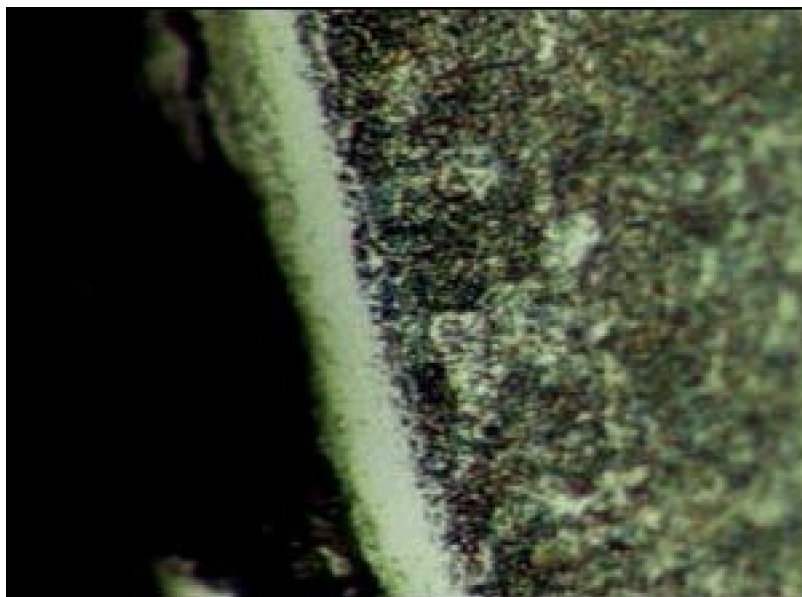
Fotomicrografía N° 1.7. Microestructura del acero SAE O-1, borde (capa blanca de compuestos, 400X, 5% nital)
