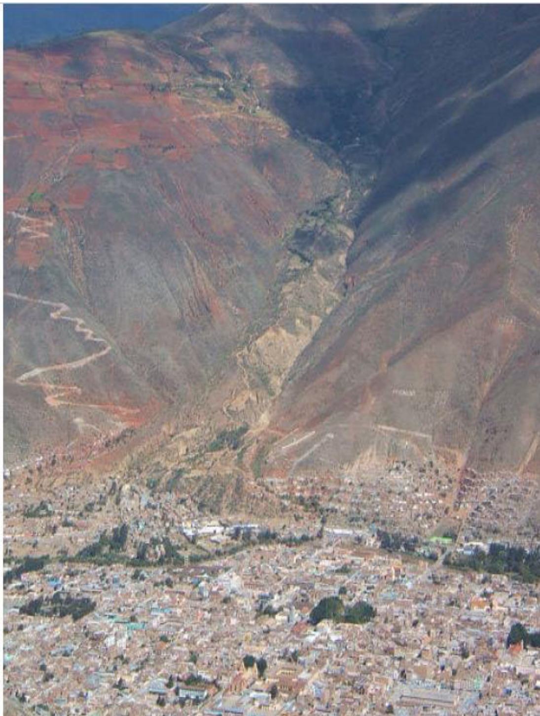
Figura 60. Vista panorámica de la quebrada Llicua de alta peligrosidad, con fuerte pendiente en sus laderas, muestra depósitos antiguos de material erosionado y su abanico con ocupación humana. Fuente. Bilberto Zabala Carrón. INGEMMET
