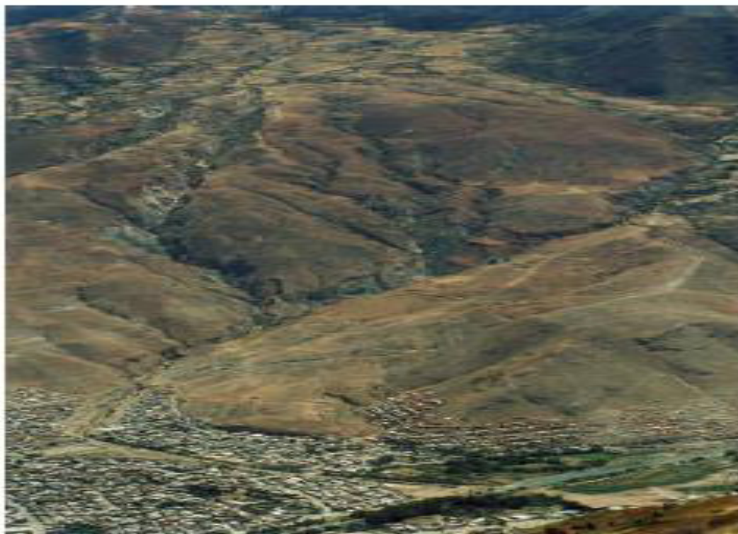
Figura 58. Vista panorámica de la quebrada La Florida. Muestra mayor erosión en la parte central y derrumbes y deslizamientos en sus márgenes. Fuente. Bilberto Zavala Carrión. INGEMMET. La descripción es nuestra
