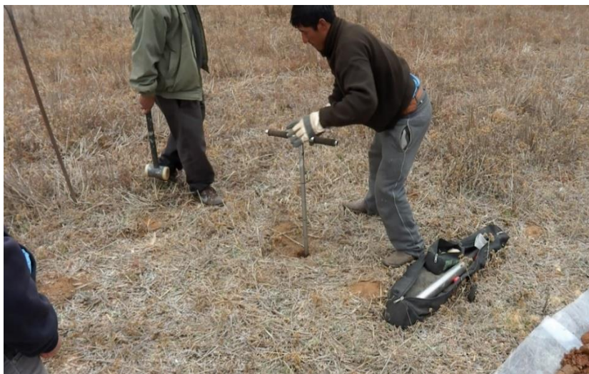
Fotografía 4. Toma de muestra de suelo.
