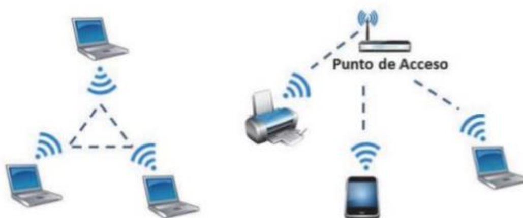
Figura 12: Conjunto de servicios básicos BSS e IBSS
