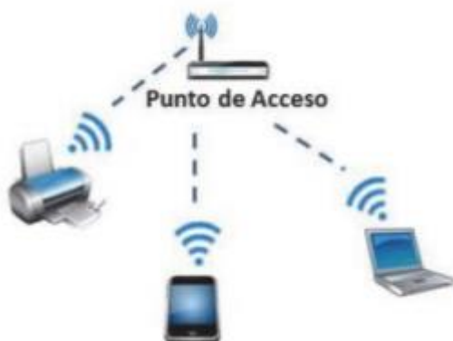
Figura 14: Red inalámbrica en modo Infraestructura
