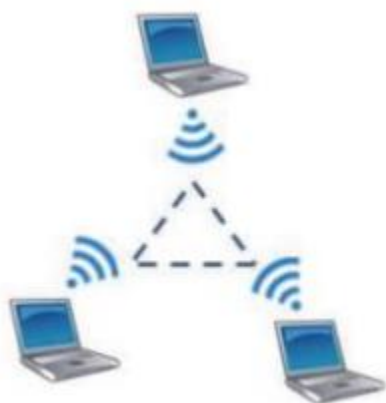
Figura 13: Red inalámbrica en modo Ad Hoc
