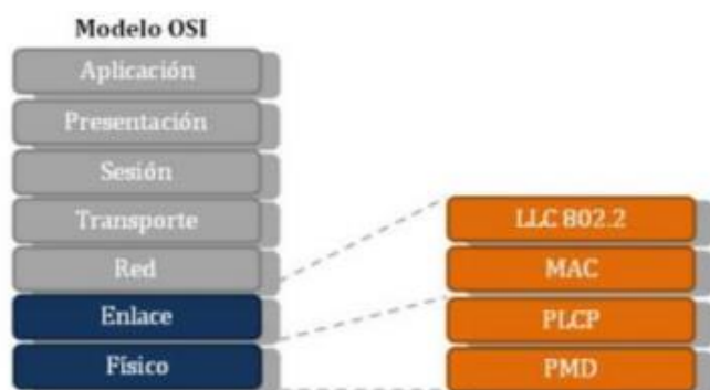
Figura 9. Capas del Modelo OSI definidas por el estándar IEEE 802.11
