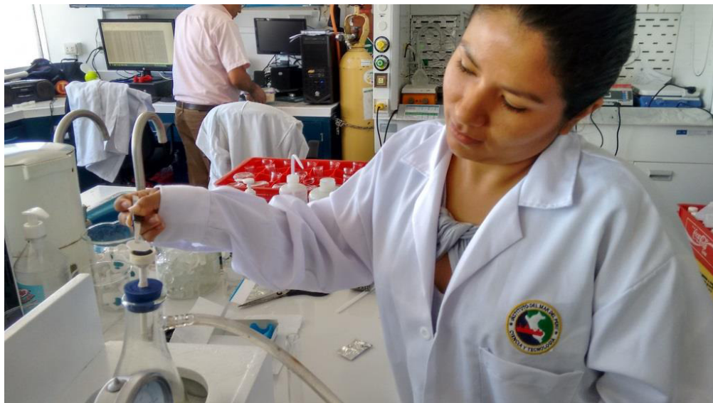
Fotografía 8: Colocación del papel filtro
