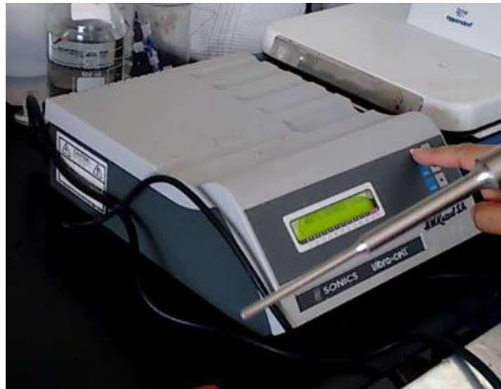
Fotografía 17: Equipo para emitir sonidos en las muestras
