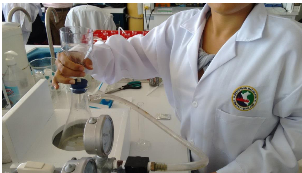
Fotografía 9: Preparación del embudo
