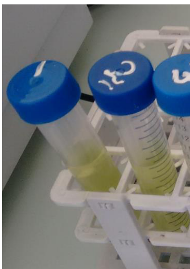
Fotografía 16: Preparación de la muestra en tubos con acetona al 90%
