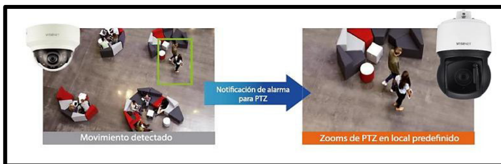
Figura 41 Demostración de la función Hand-Over
